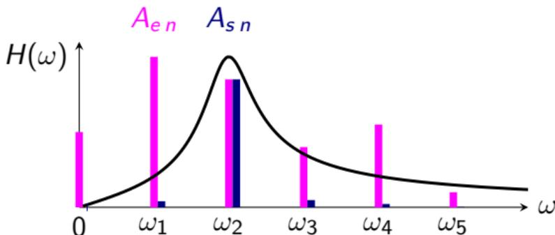
Le signal de sortie est ici quasi sinusoidal.
