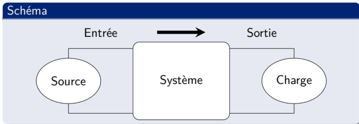
La source et la charge sont souvent d'autres systèmes électroniques.
