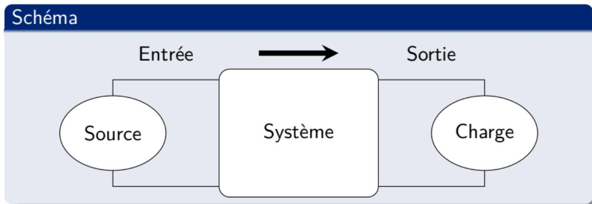
Le système est, en général, **unidirectionnel**. Il ne peut être utilisé en plaçant le signal d'entrée en sortie.
