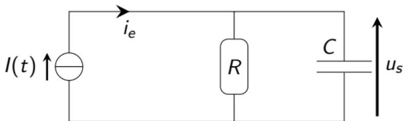
1) Établir la relation différentielle liant  $u_s$ , tension de sortie, et  $i_e$ , courant d'entrée. En déduire la fonction de transfert (ou transrésistance)  $\underline{H}_R = \frac{u_s}{i_e}$ . Pourquoi ce nom de transrésistance ?
