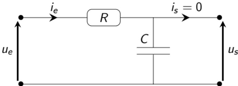
Attention : il existe à l'entrée un système (générateur) non représenté qui impose la tension  $u_e$  ! Il y a *a priori* une intensité d'entrée  $i_e$  non nulle.
