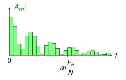
$|A_m|$  est l'amplitude du signal sinusoïdal numérique de fréquence  $f_m=m\frac{F_e}{N}.$
