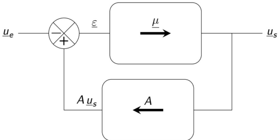
La connexion en entrée réalise une **réaction positive**.
