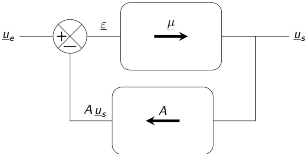
La connexion en entrée réalise une **contre-réaction**.
